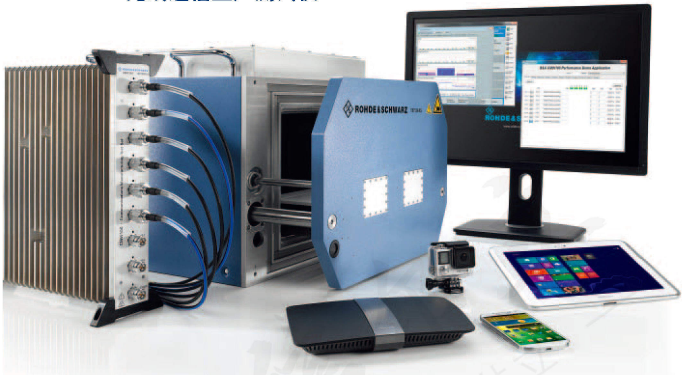
R&S®CMW100与R&S®TS7124射频屏蔽箱携手设备测试
