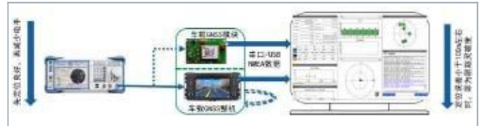
图19 跟踪灵敏度测试框图
