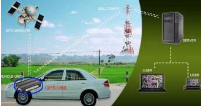
图40 被盗车辆跟踪SVT工作原理图
