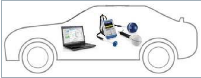
图18 手持仪表FSH/FPH/MNT100结合全向天线TS-EMF的场强测试
